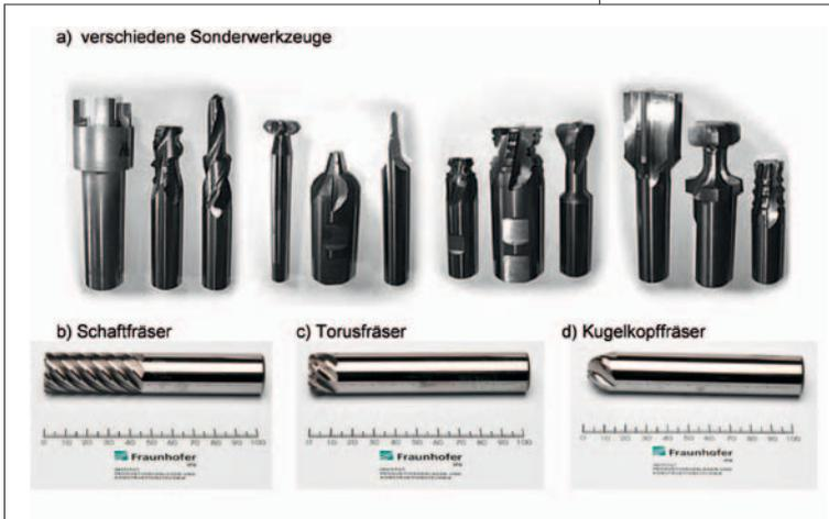
Beim Einsatz der Werkzeuge in der Praxis konnten im Vergleich zum Ausgangszustand (Versuchswerkzeug 1) mit den Versuchswerkzeugen 4 und 5 doppelt so viele Bauteile bearbeitet werden.
